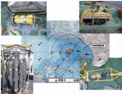
CO 2 海底漏出を計測する機器
