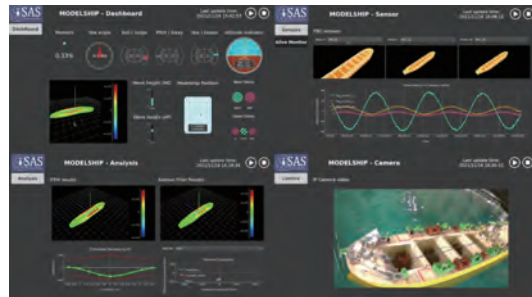
i-SASにより開発された模型船のデジタルツインシステム GUI of digital twin system (i-SAS) for a model ship
