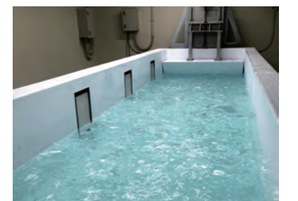
氷縁域再現水槽 (冷凍室内に設置された造波水槽) A wave-tank placed in a low-temperature room.
